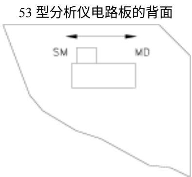
图3-3 单分析仪模式/多分析仪模式开关位置 (仅用于装备有 HART 的分析仪)
